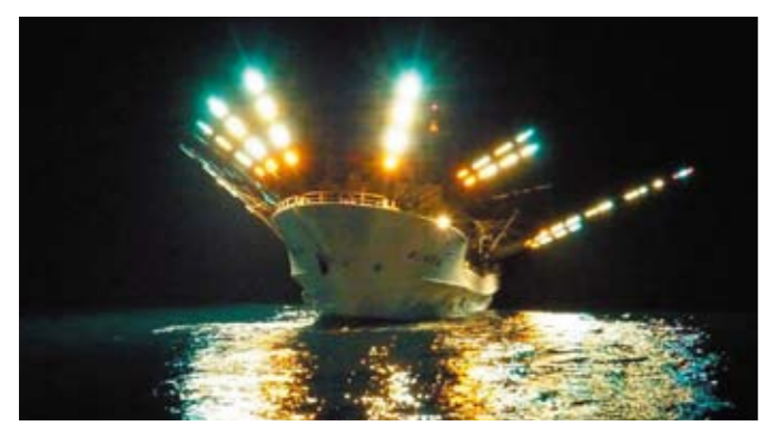
漁船の先端に取付け海を明るく照らすLED集魚灯
