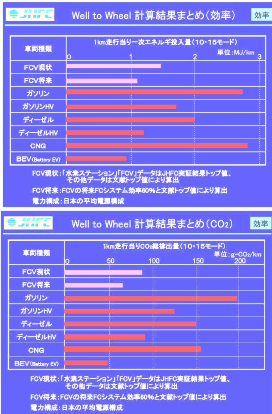
図表 2-4 Well-to-Wheel の温室効果ガス排出量の算出結果
