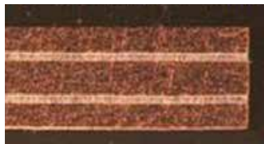
Cu-Mo-Cu の切断面
