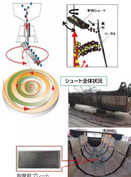
高炉原料装入装置
