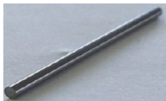
鑄ぐるみ材：超硬 硬さ：1700~2000HV
