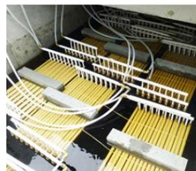
プラスチック樹脂製熱交換器
