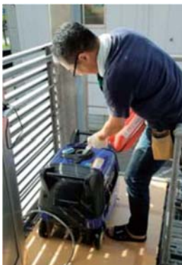
発電機にガソリンを入れる様子
