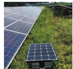
自動走行中の雑草管理ロボット (中央下・上面パネルで電力補充)
