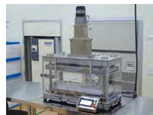
医療製品をパッケージする為の、樹脂ケースと滅菌フィルムを熱溶着させる機械「トレーシーラー」
