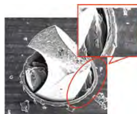
加工中に折損したドリルと穴入口付近の様子
