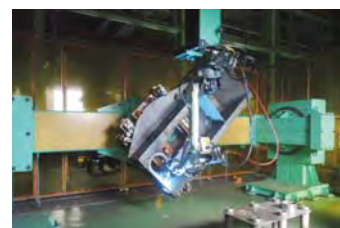
溶接ロボット
