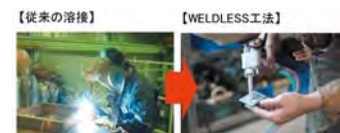
溶接不要な「WELDLESS 工法」
