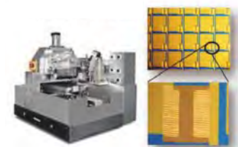
有機半導体結晶膜塗布装置と表示画素駆動デバイス
