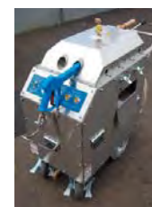
電子蒸気発生器
