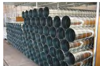
スパイラルダクト
