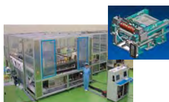
液晶カラーフィルター製造装置と塗布動作部構造
