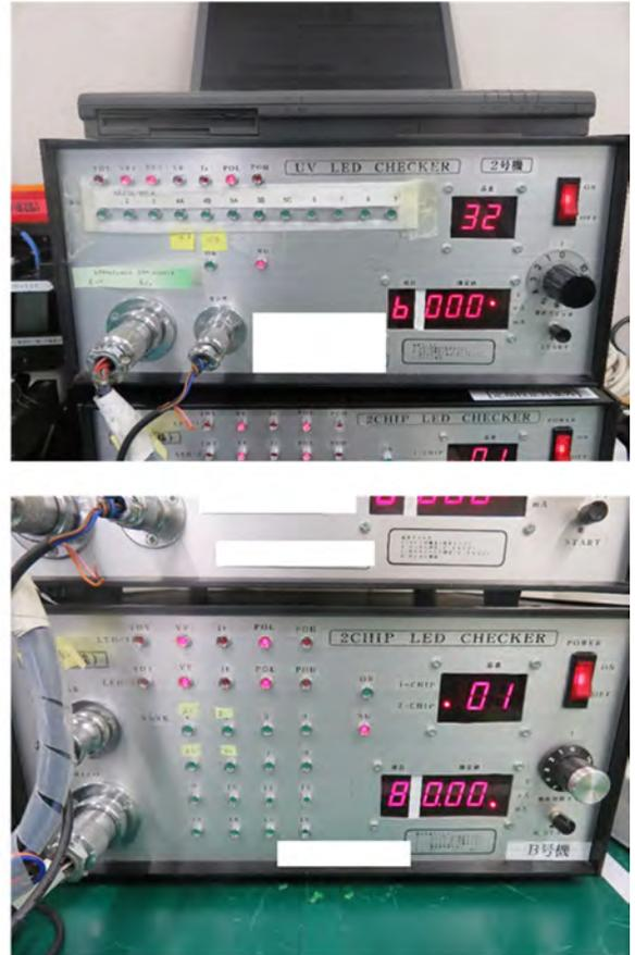
LED の電流、電圧、光出力等の特性評価を行うチェッカーの更新 (OS 含め)
