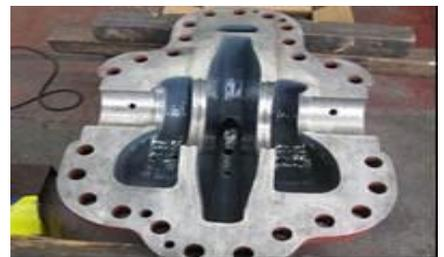
これは、排水用ポンプであり、通常は損傷が激しく修理ではなく新規製作と判断される。(株)西野製作所と日鋼デザイン(株)が連携して3次元測定や溶接肉盛を行い、修理可能となった事例。
