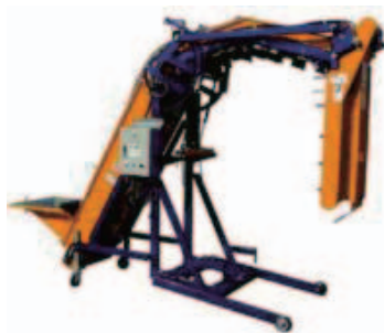
センサーコントロールエレベータ
