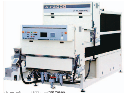
小麦グレードアップ選別機 小麦粒から低アミロ粒、赤カビ粒などを除去し品質を上げる
