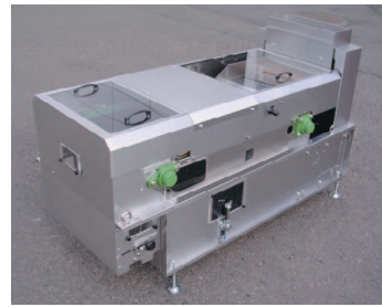
マグネットソーター ネオジム磁石で穀類中の石・土塊を除去
