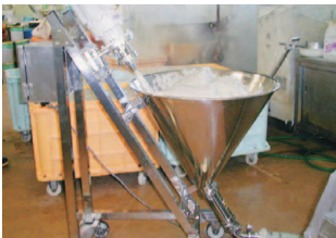
すり身移送ポンプ
