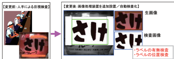
ラベルの検査自動化（画像検査）
