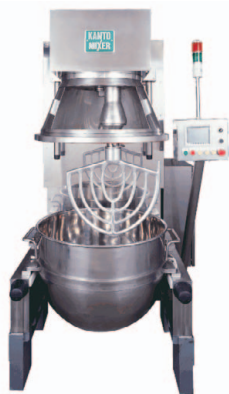
ステンレス製ミキサー KTM型 ヘッド上昇時 ボール容量10リットルから400リットルの豊富な機種でお客様のご要望にお応えいたします。
