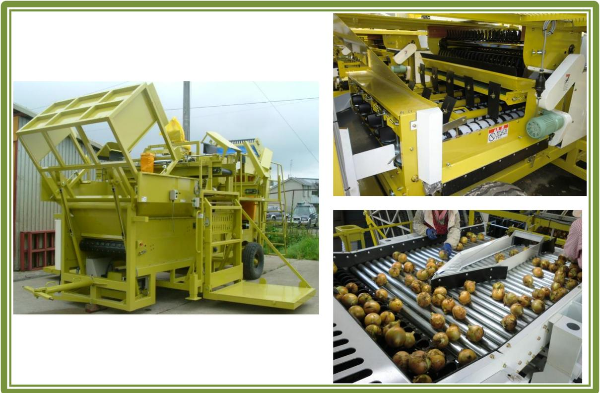
受賞者は、日本一のタマネギの生産地(全国の30%)である北見地方の農家の要望に答え、茎葉切断(タッピング)の精度が高く、タマネギの損傷が少ない定置式オニオンタッパーを開発。
