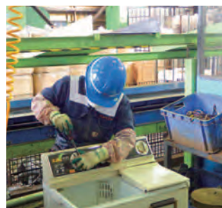
手作業によってネジ1本ビス1本まで選別 (家電のリサイクル)
