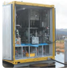
バイオガス精製圧縮充填装置
