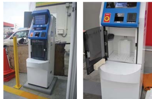
灯油自動給油機
