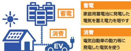
昼間に発電して、電気製品などの電力に使用しつつ、余った電力を蓄電池に貯めることで、夜間に使用することができます。
