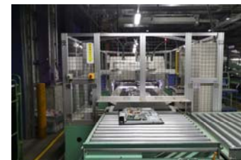
ロボットによるパソコン基盤のネジ外しの様子
