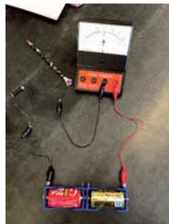
電池の量と電流の大きさ
