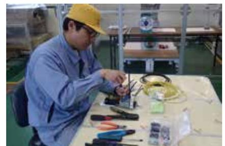
品質、技能レベルを管理確認するための配線端末処理試験
