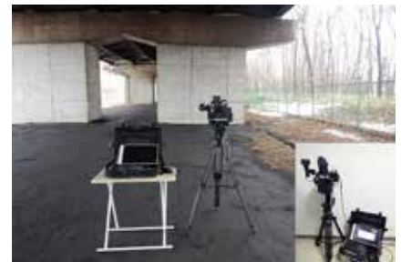
超高精細画像を用いた点検システム
