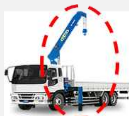
トラック搭載型クレーン
