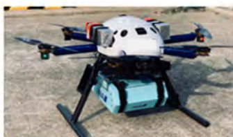
短距離(マルチコプタ) 航続距離: ~ Payload: ~ 1.7kg
